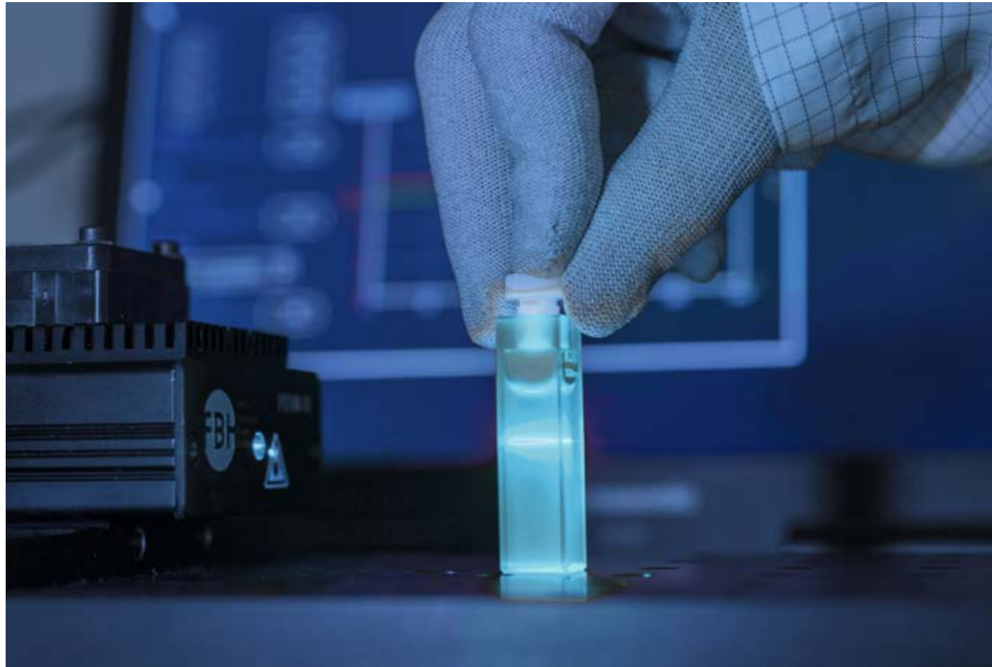
➤ Dual-wavelength diode laser system used in the laboratory for Raman measurements. Zweiwellenlängen-Diodenlasersystem, das im Labor für Raman-Messungen eingesetzt wird.
