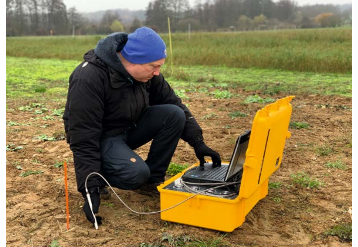
➤ FBH's portable SERDS sensor system in a real-world test. The system successfully performed Raman measurements in a field. Tragbares SERDS-Sensorsystem des FBH im Feldeinsatz. Damit wurden erfolgreich erste Raman-Messungen auf einem Acker durchgeführt.
