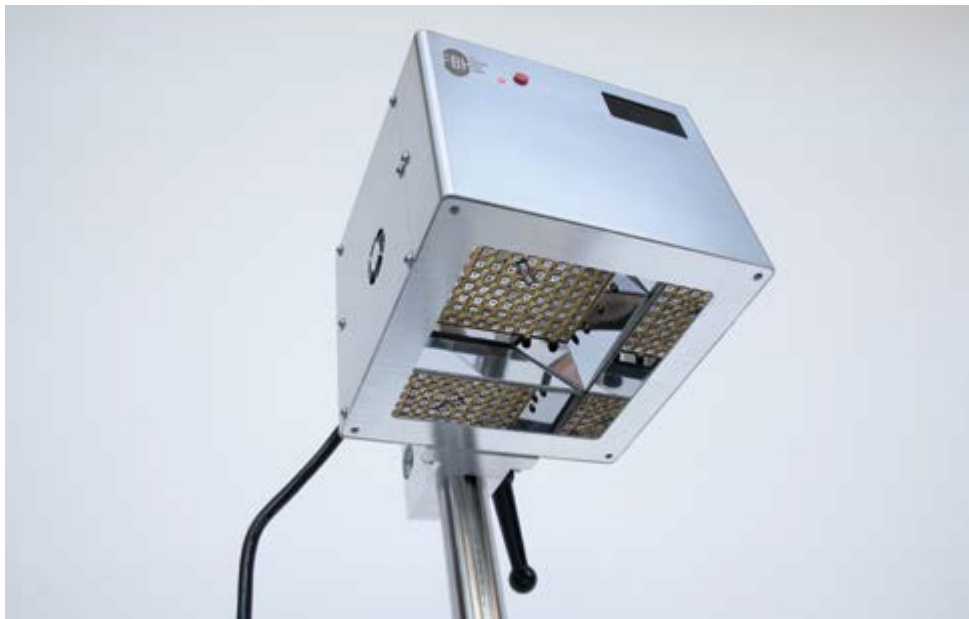
➤ Irradiation system with UVC LEDs used in the VIMRE project for medical tests on skin models and skin by Charité and Greifswald University Medical Center. Bestrahlungssystem mit UVC-LEDs, das im Projekt VIMRE für medizinische Tests an Hautmodellen und Haut von der Charité und der Universitätsmedizin Greifswald genutzt wird.
