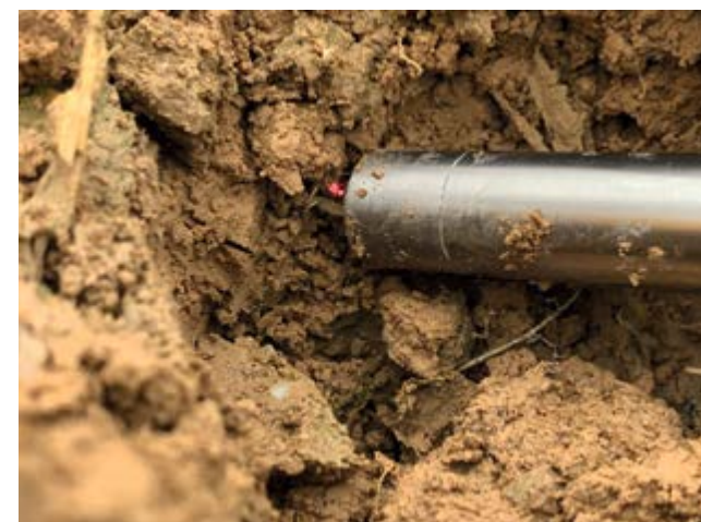
Customized Raman probe used for laboratory investigations (above) and for in situ SERDS soil analysis in the field (below). Maßgeschneiderte Raman-Optode, die für Laboruntersuchungen (oben) und für die in-situ Bodenanalyse mittels SERDS im Feld (unten) eingesetzt wurde.
