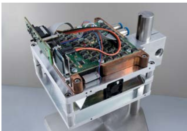
➤ Operating electronics of an LED irradiation system with 120 UVC LEDs on an individual heat sink, integrated with reflector box and display electronics. Betriebselektronik eines LED-Strahlers mit 120 UVC-LEDs auf einem individuellen Kühlkörper, integriert mit einem Reflektorkasten und Anzeigeelektronik.
